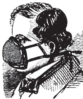
Рис. 21. Противогазовый респиратор Стенхауза с активированным углем
